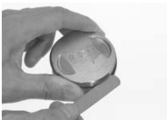
Inserire in squadra ogni fascia elastica nella parte inferiore del cilindro utilizzando il pistone.
