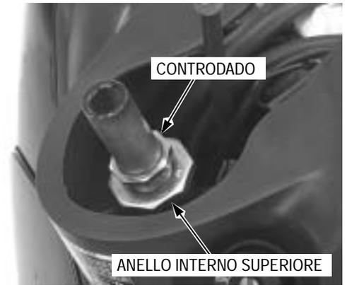
Rimuovere l'anello interno superiore sostenendo il piantone dello sterzo.
