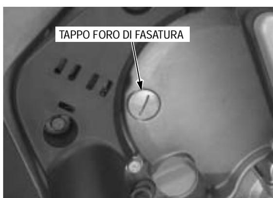
Ruotare la puleggia conduttrice (albero a gomiti) in senso antiorario e allineare la marcatura "T" sul volano con l'intaglio riportato sul coperchio del basamento.
