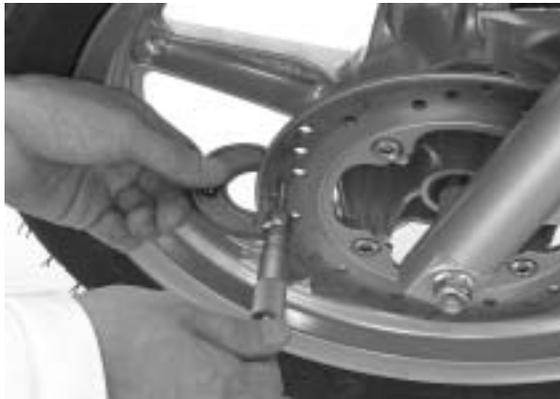
Misurare la deformazione del disco del freno con un comparatore a quadrante.
