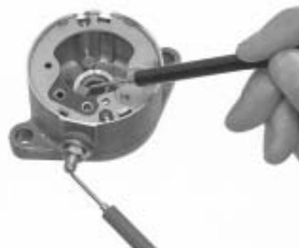
Controllare se vi è continuità fra il morsetto del cavo e il coperchio posteriore.
