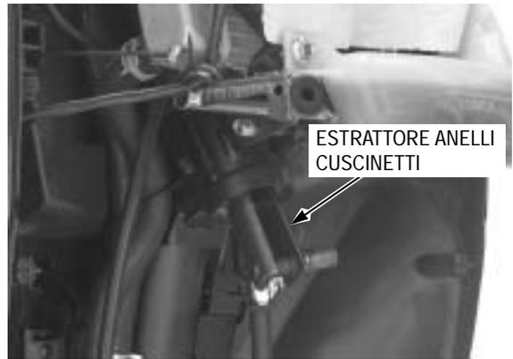
Installare il dado del piantone sterzo sul piantone per non danneggiare le filettature quando si rimuove l'anello interno del cuscinetto inferiore.
