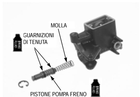
*Controllare che l'anello elastico di ritegno sia ben alloggiato nella scanalatura.* Installare l'anello elastico di ritegno nella scanalatura della pompa freno con il lato smussato rivolto verso il pistone.
