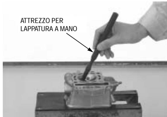
*La valvola non può essere rettificata. Se la faccia di una valvola è bruciata o molto usurata o se i contatti con la sede sono irregolari, sostituire la valvola.*
