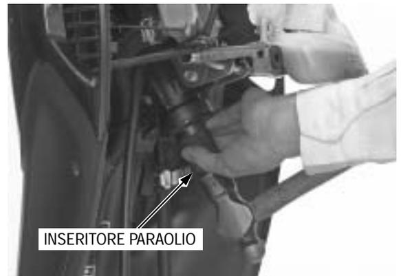
Inserire un nuovo anello esterno superiore nel tubo della testa di sterzo.
