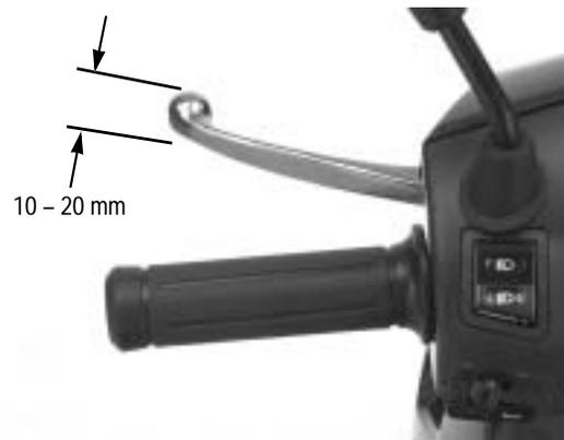
Regolare la corsa a vuoto ruotando il dado di regolazione. Assicurarsi che l'incavo del dado di regolazione sia in battuta sulla spina del braccio del freno.
