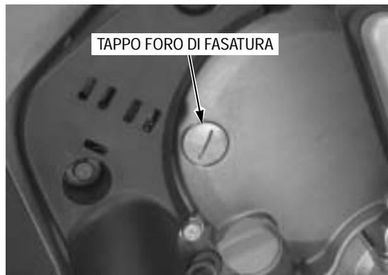
Ruotare la puleggia conduttrice (albero a gomiti) in senso antiorario e allineare la marcatura "T" sul volante con l'intaglio riportato sul coperchio del basamento.
