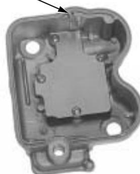
Installare il collare di raccordo nella testata.
