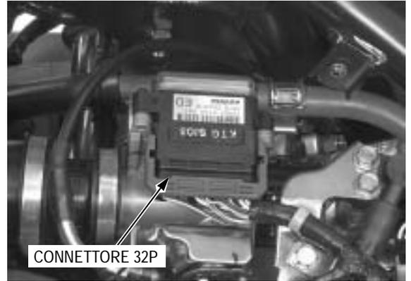
Collegare il cablaggio di prova ECM tra l'ECM e il connettore ECM.
