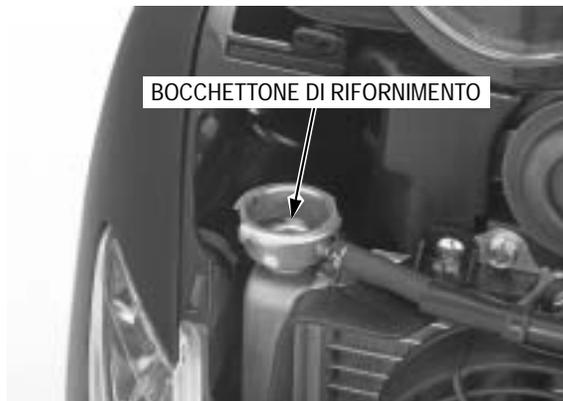
Riempire il serbatoio di riserva fino alla tacca di livello massimo e installare il tappo del serbatoio.
