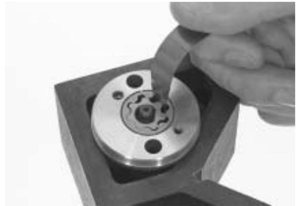
Misurare il gioco fra il rotore esterno e il corpo della pompa dell'olio.
