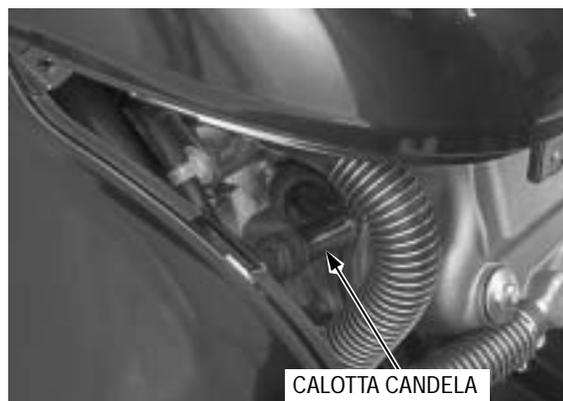
Collegare una candela in buone condizioni alla calotta e collegarla a massa sul cilindro come viene fatto per la prova della scintilla.
