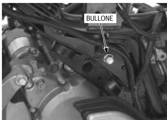
*L'altezza del martinetto deve essere regolata per ridurre il carico e facilitare la rimozione del bullone.*
